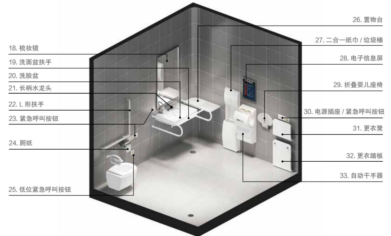
无障碍卫生间要素示意图 (注：图选自《无障碍卫生间设计要点图示图例解析》)
