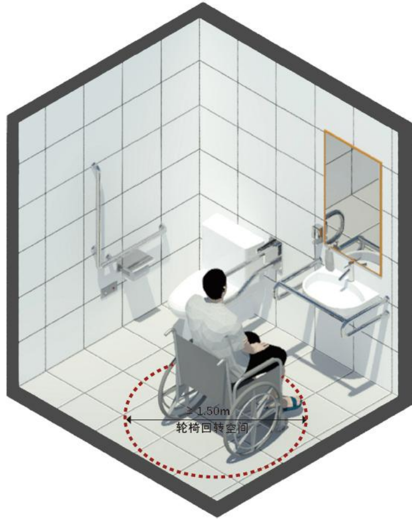
无障碍卫生间轮椅回转空间示意图 (注：图选自《北京2022年冬奥会和冬残奥会无障碍指南技术指标图册》)
