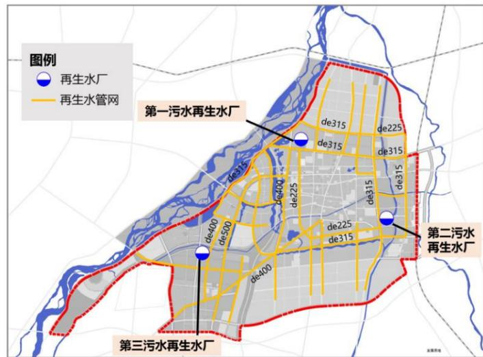
图 8-2 规划再生水系统布局图
