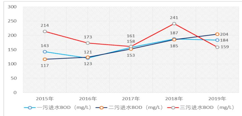
图 4-26 第一、二、三污水厂进水 BOD 浓度变化示意图
