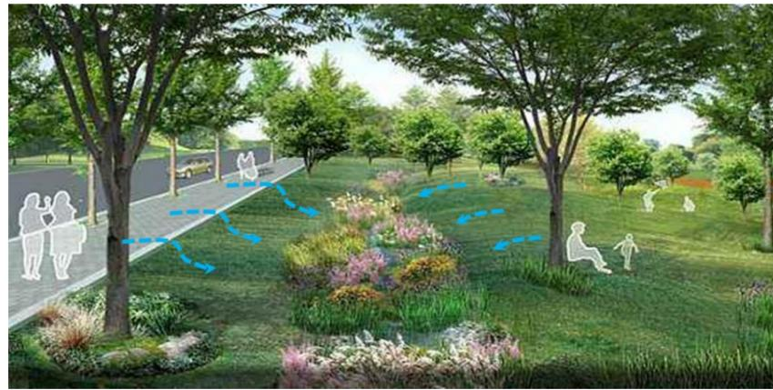
图 10-21 典型道路雨水径流组织示意图（一）
