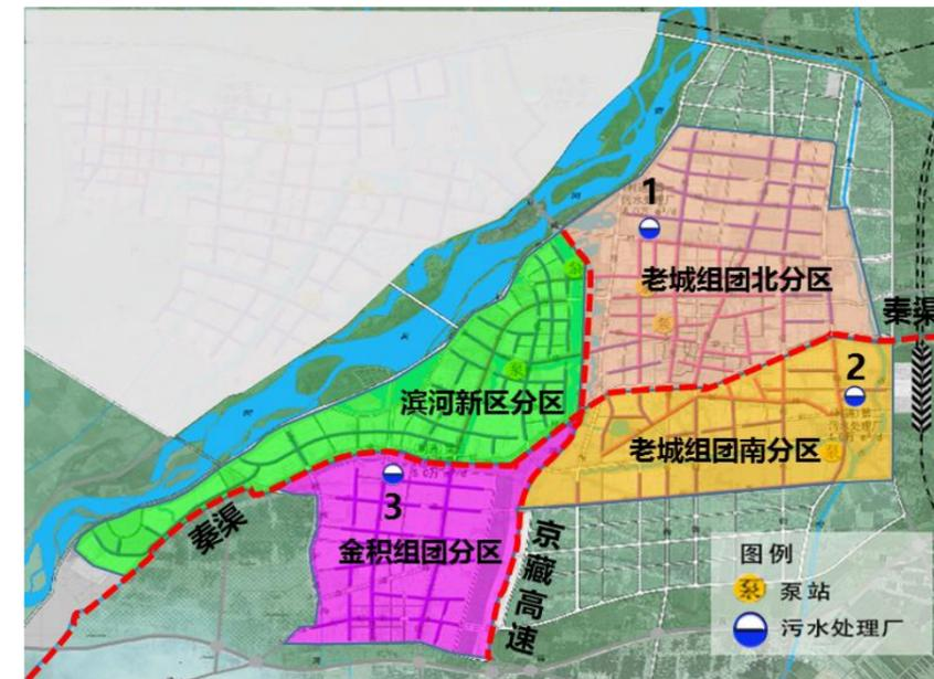
图 1-3 污水系统规划图
