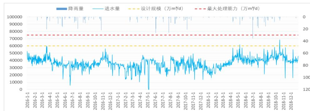
图 4-5 2016~2018 年第一污水厂进水量示意图
