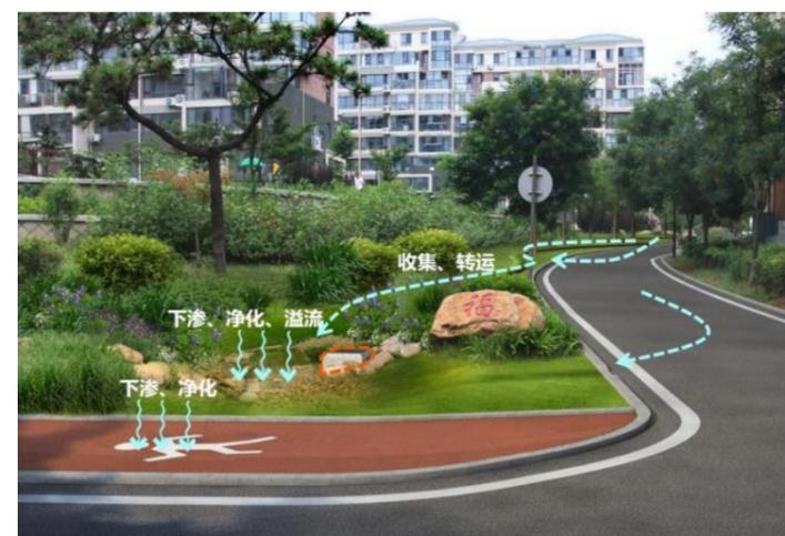
图 10-13 典型小区雨水径流组织示意图（二）
