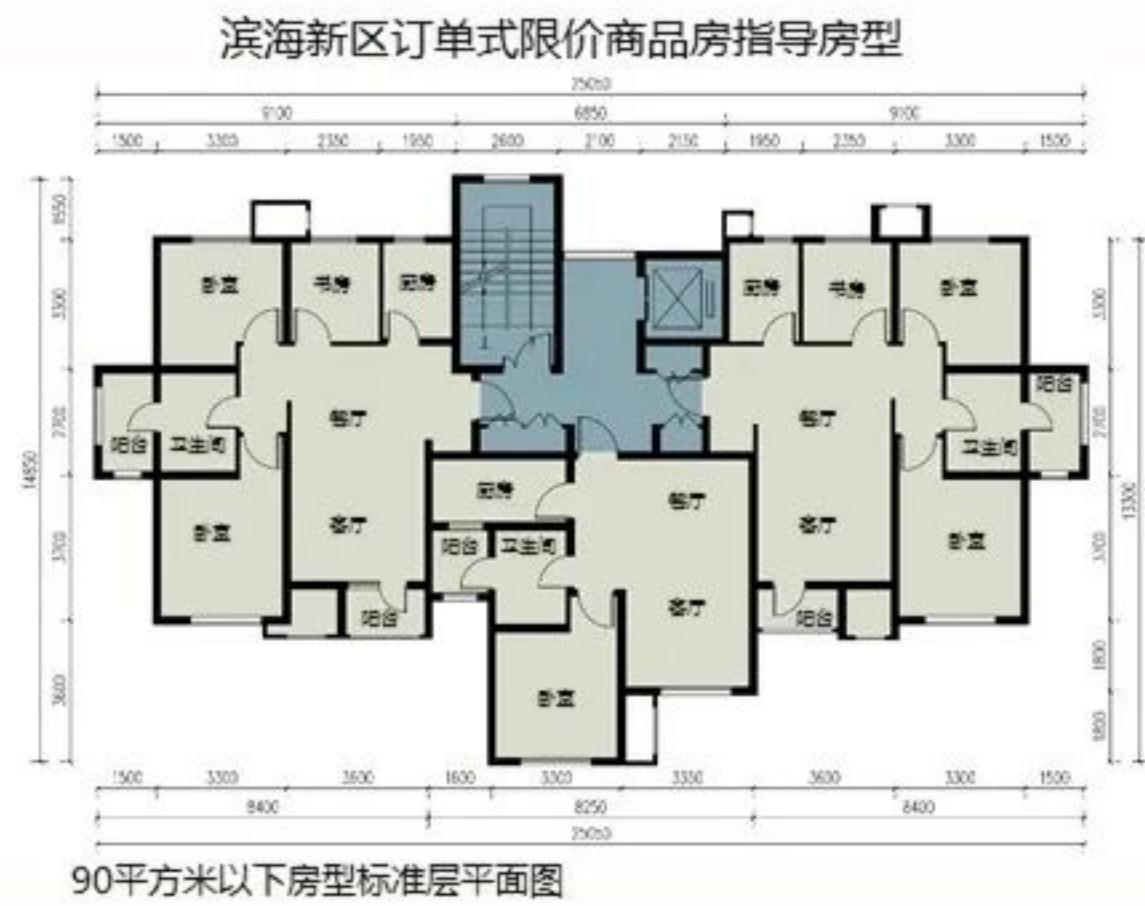
90平方米以下房型标准层平面图
