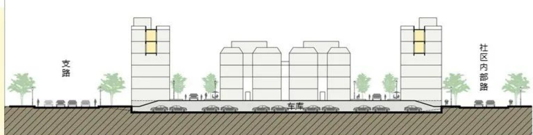
半地下室停车库的地下室顶板上皮结构标高高于室外地坪小于或等于1.50m的，该部位对应建筑面积不计入容积率。
