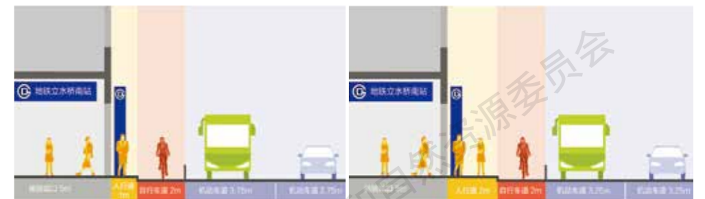
改造前断面示意图 Before renovation
