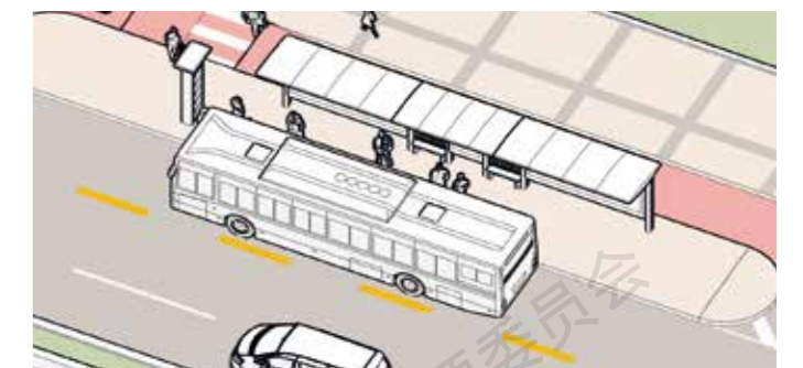
路侧岛式公交站 Road side island bus stop
