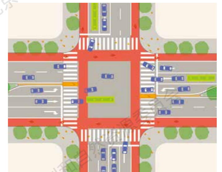
四车道利用中央分隔带增加左转车道，避免展宽红线，路中设置过街安全岛。
