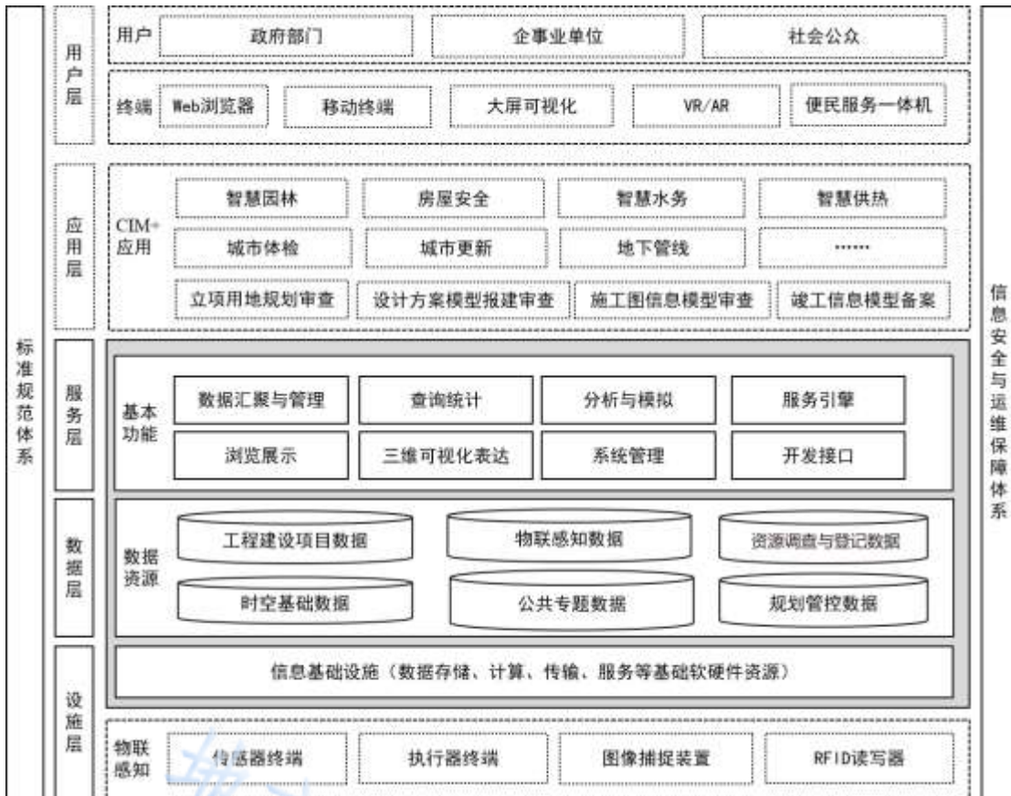
图 3.2.1 CIM 基础平台总体架构及其支撑作用
