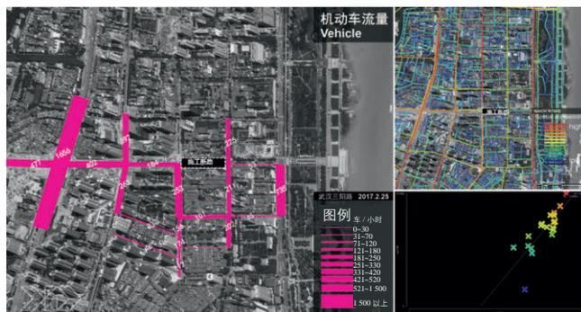
图 6 基于无人机航拍视频获取的道路截面车流量数据空间句法分析
