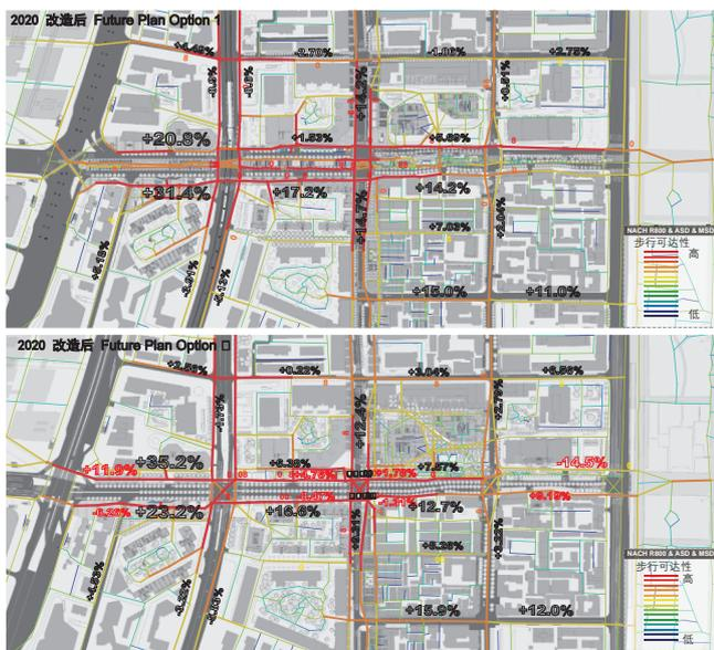
图 8 设计方案 1 与设计方案 2 的步行量分布对比
