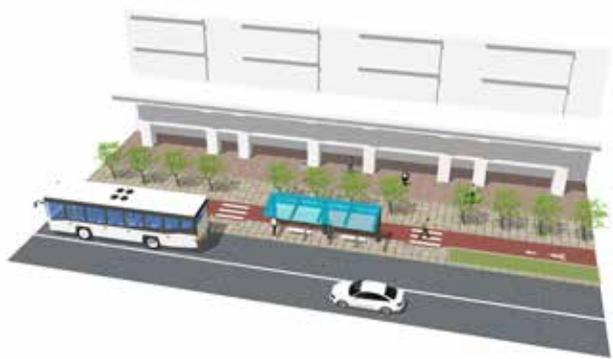
图 2-6 | 港湾式公交停靠站(设置在路侧隔离带)
