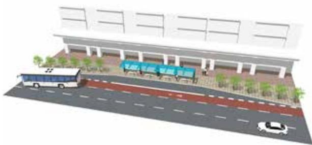
图 2-5 | 直线式公交停靠站(设置在路侧隔离带)
