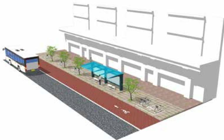
图 5-13 | 结合路边停车泊位设置自行车停车设施
