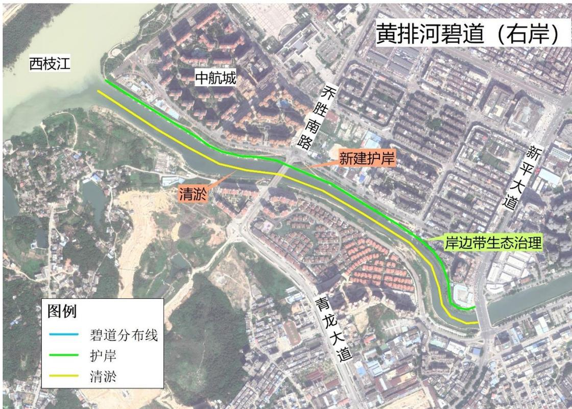
图 6.2-33 黄排河碧道水利工程总体布局示意图
