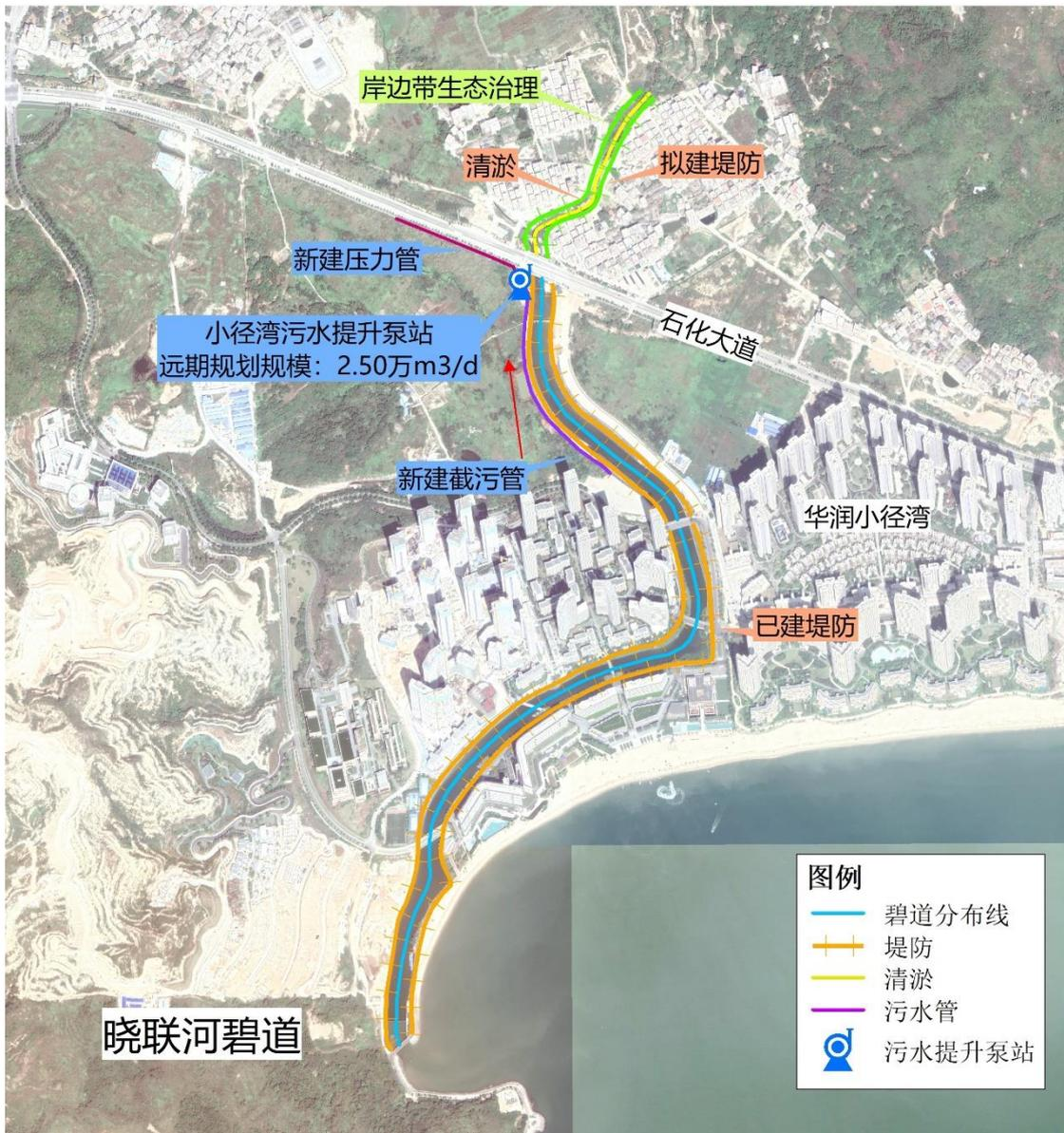
图 6.8-16 晓联河碧道水利工程总体布局示意图
