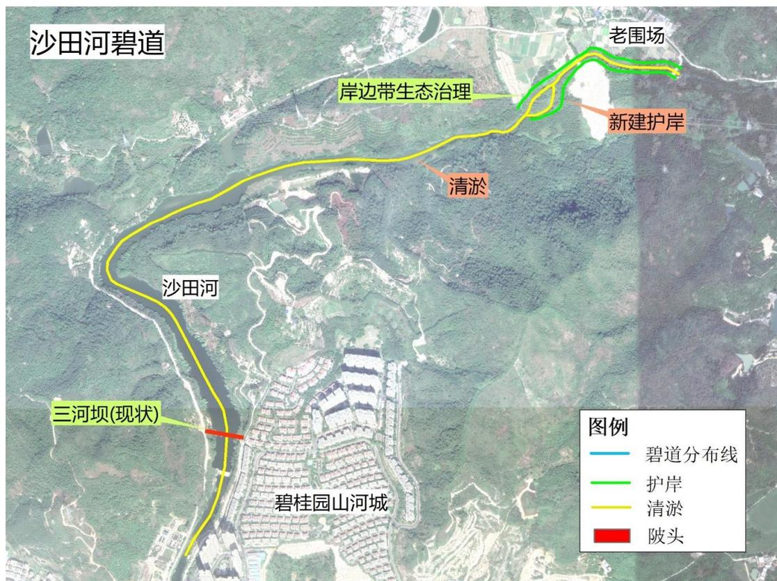
图 6.5-18 沙田河碧道段水利工程总体布局示意图
