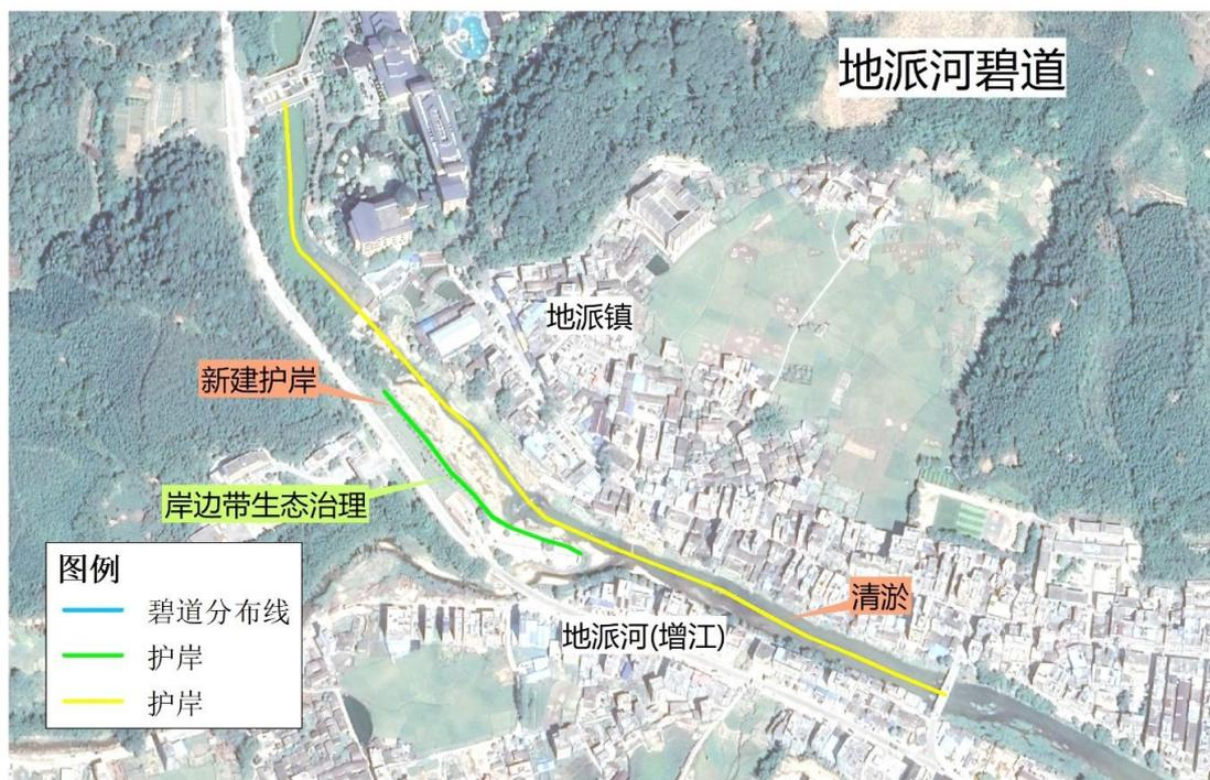
图 6.7-19 地派河碧道水利工程总体布局示意图
