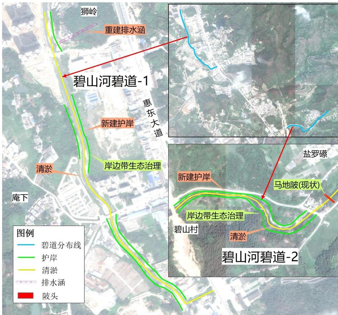
图 6.2-26 碧山河(陈塘段)碧道水利工程总体布局示意图
