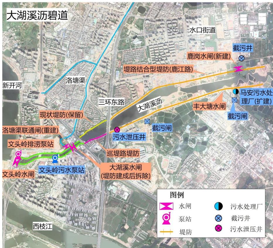
图 6.2-11 大湖溪沥碧道水利工程总体布局示意图
