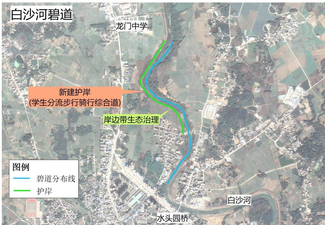
图 6.1-21 白沙河碧道水利工程总体布局示意图
