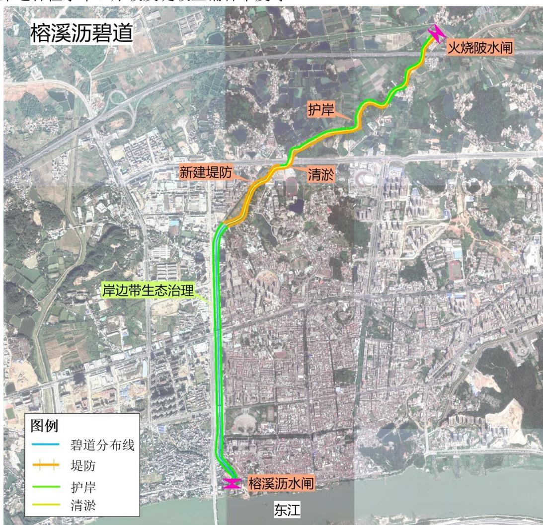
图 6.1-48 榕溪沥碧道水利工程总体布局示意图
