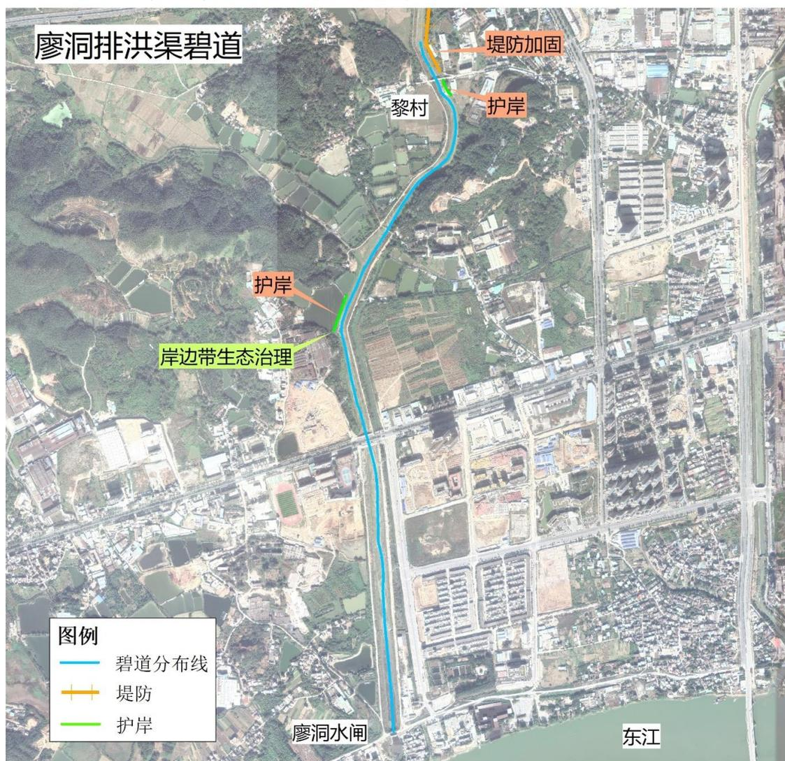
图 6.1-50 廖洞排洪渠碧道水利工程总体布局示意图
