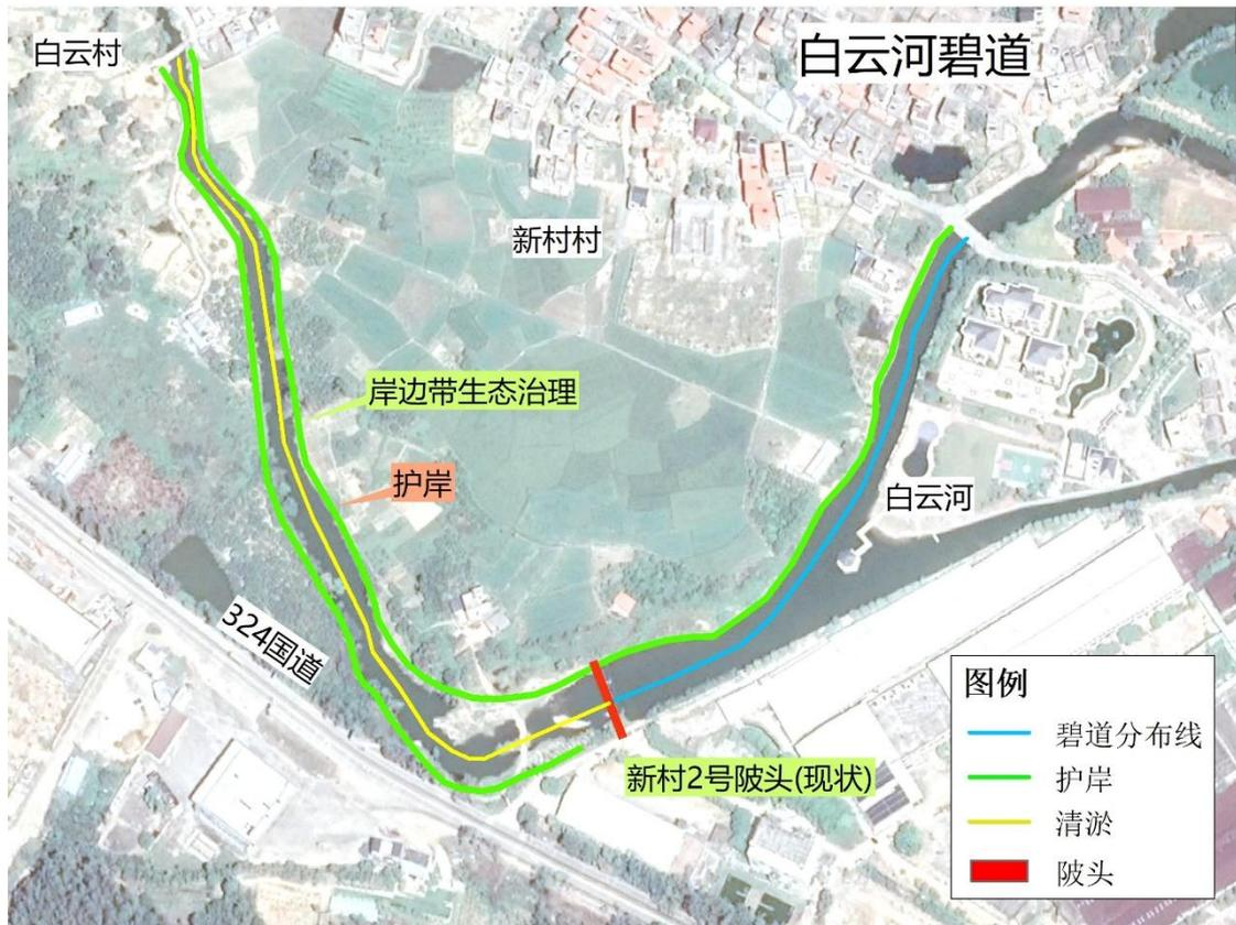
图 6.8-19 白云河新村段碧道水利工程总体布局示意图
