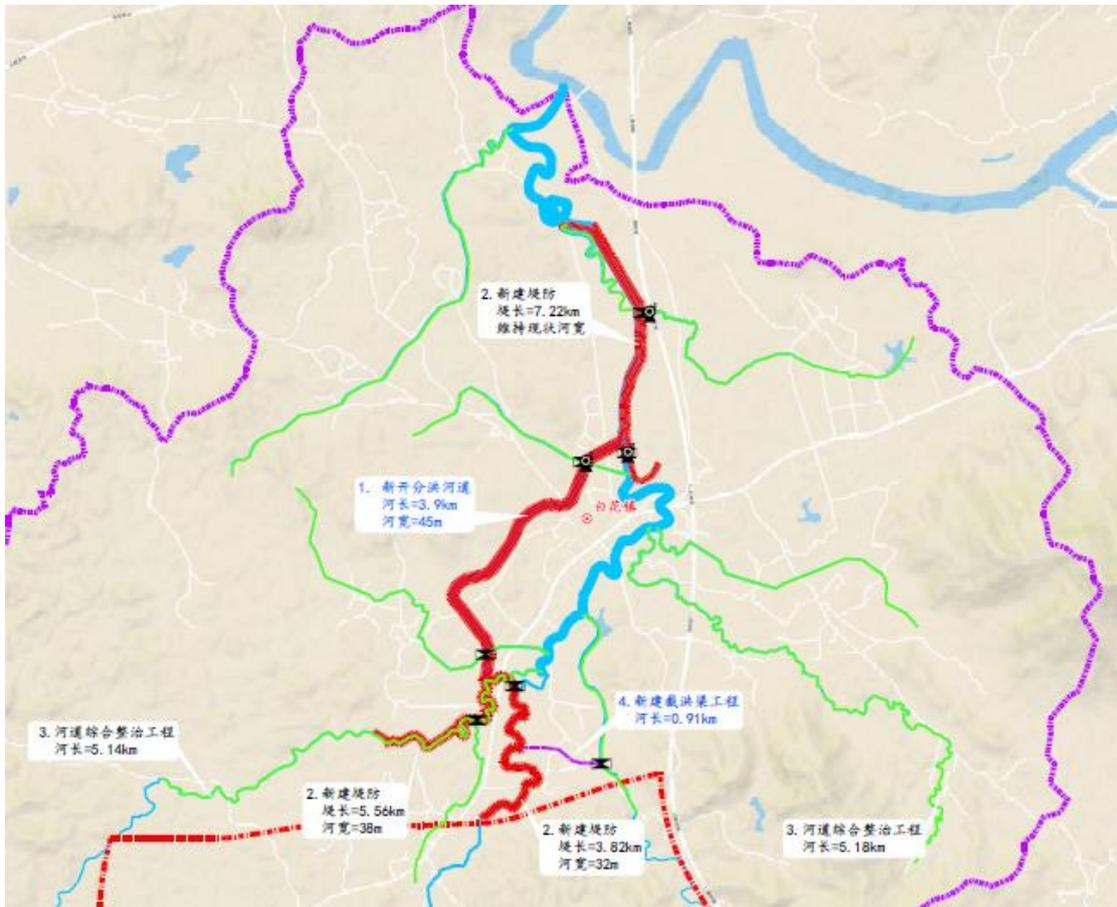
图 6.2-34 新开河碧道水利工程总体布局示意图
