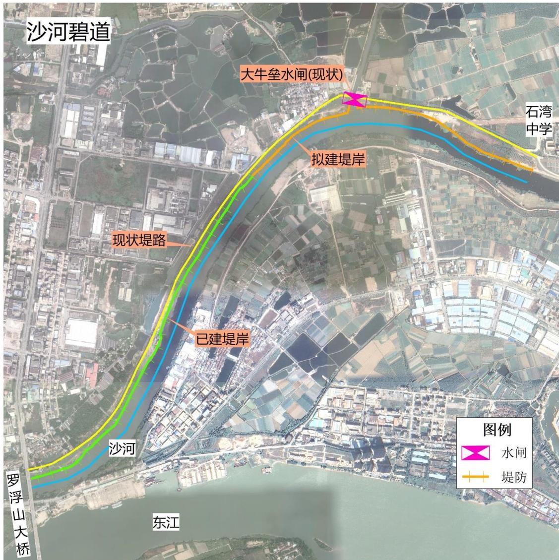
图 6.6-13 沙河石湾段碧道水安全总体布局示意图
