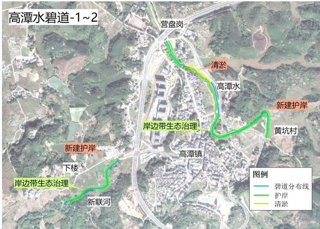
图 6.2-17 高潭水碧道水利工程总体布局示意图
