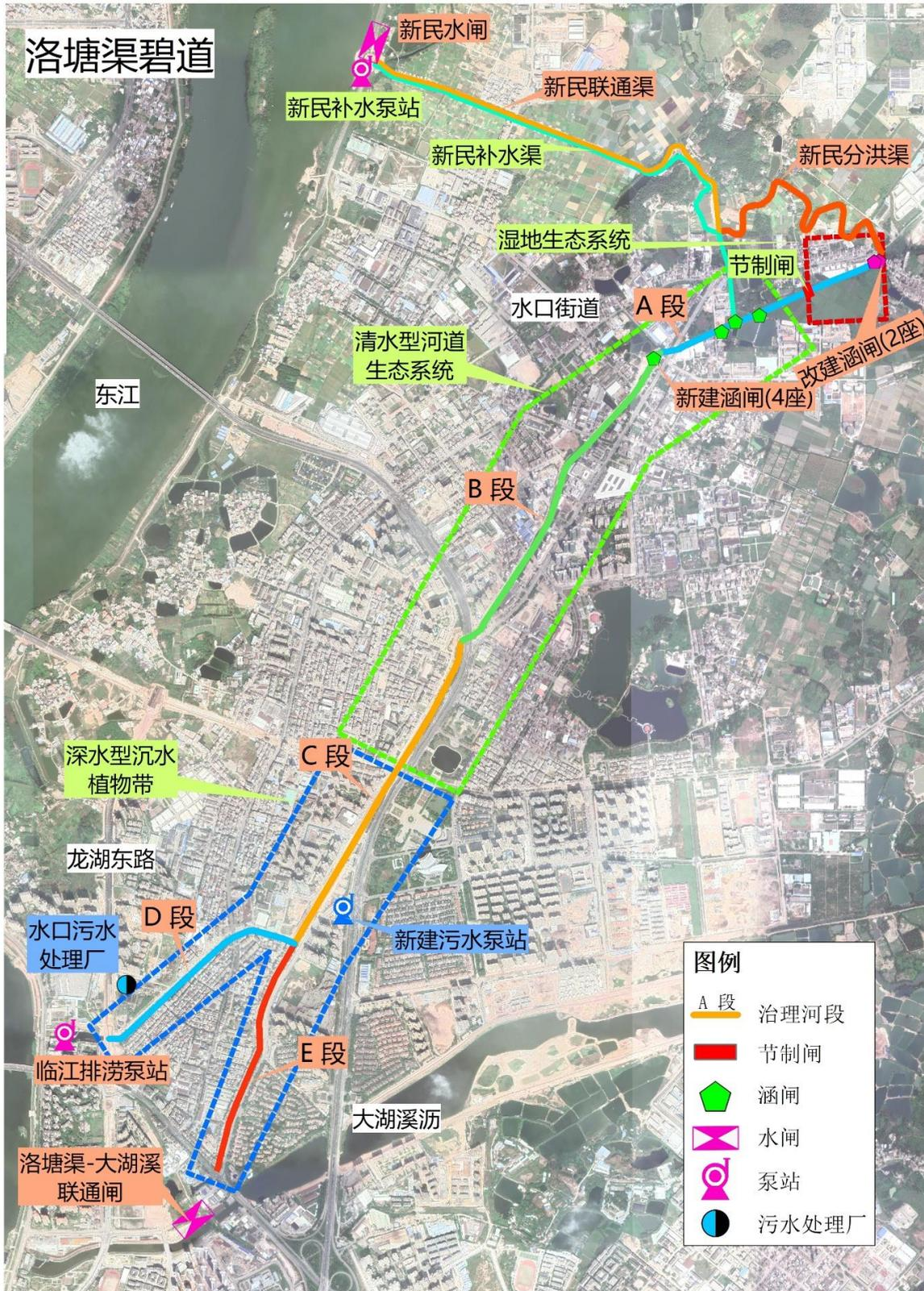
图 6.1-46 洛塘渠碧道水利工程总体布局示意图
