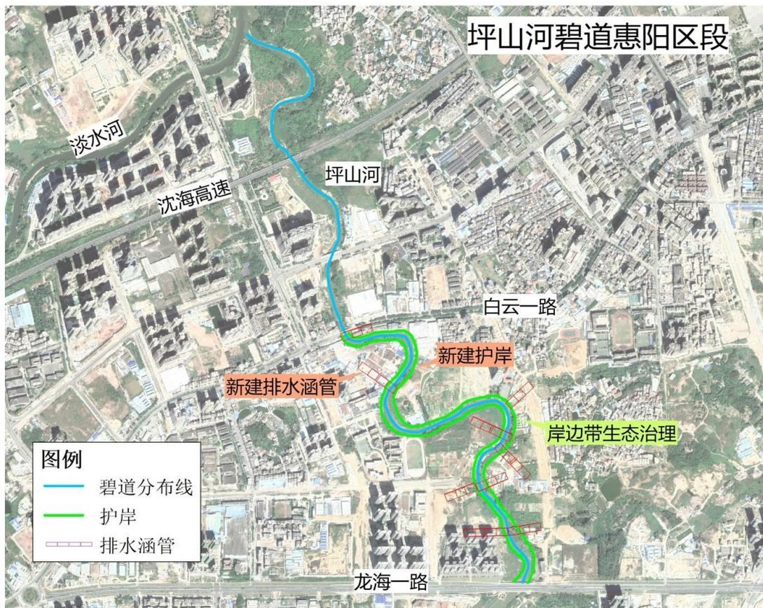
图 6.5-21 坪山河碧道段水利工程总体布局示意图
