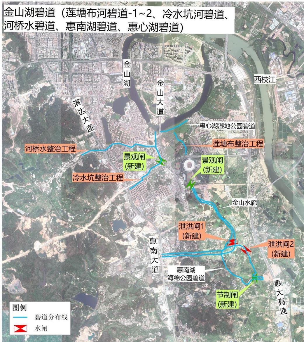
图 6.2-38 金山湖碧道水利工程总体布局示意图
