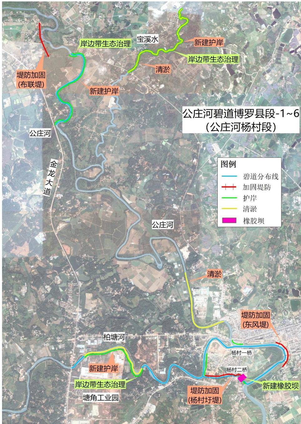
图 6.3-12 公庄河杨村圩镇段碧道水利工程总体布局示意图
