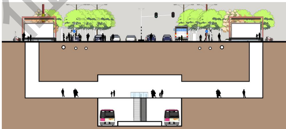
图 9 地下过街通道与轨道交通站点出入口共同设置示意
