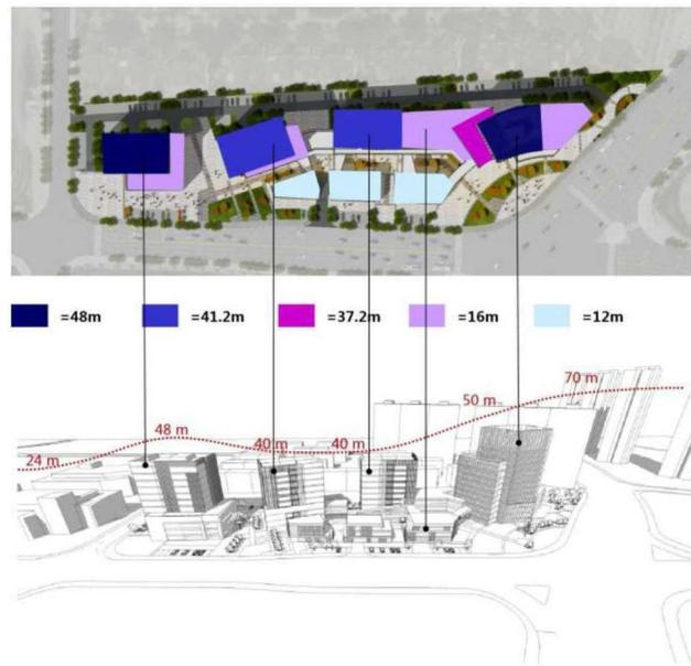
图 7 塔楼建筑高度分析示意图
