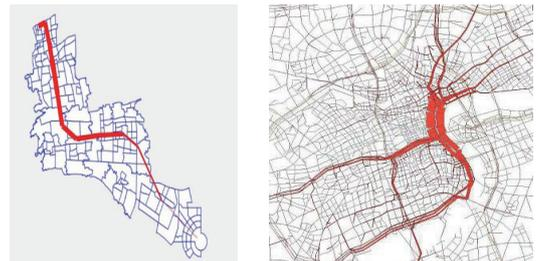
图5 轨交16号线的客流预测及外滩通道的车流分布预测
