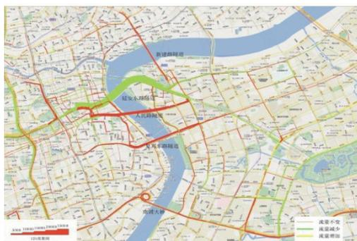
图9 延安东路隧道东向西方向关闭后的交通流分布图
