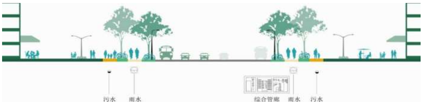
市政管线设置示例图二（综合管廊）
