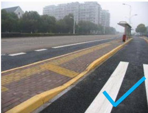
无障碍坡道应满足相关设计规范要求，将坡道坡度控制在规范要求范围内，并做好相应防滑措施。
