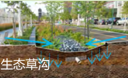
街道 通过生态保持带的洼地来组织输送地表雨水；提供基地内河渠的汇水点(当街道中线有水道、沟渠出现时)
