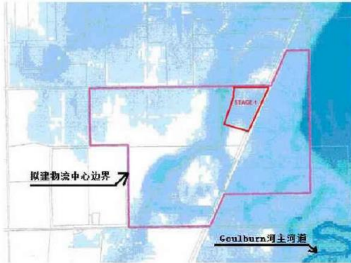
图2 拟建物流中心现状100年一遇洪水淹没图（MIKE21二维洪水数学模型）
