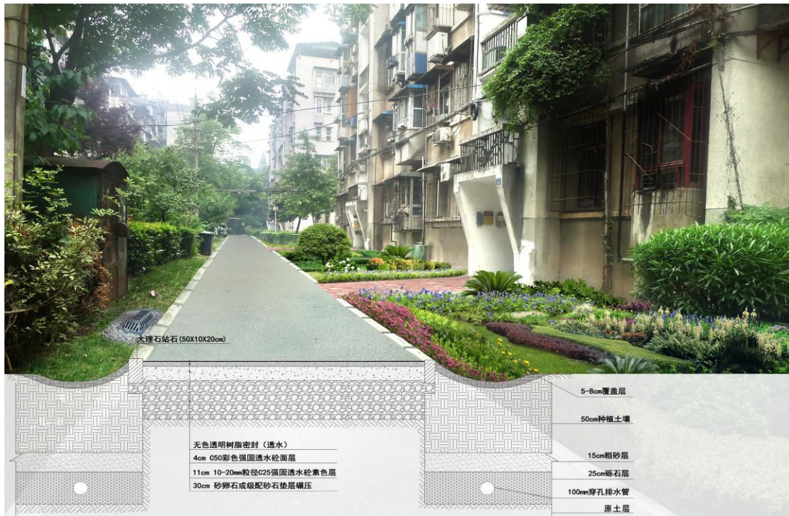
图 8.5.4 (1) - 2 透水铺装及两侧植草沟实景图 (二)
