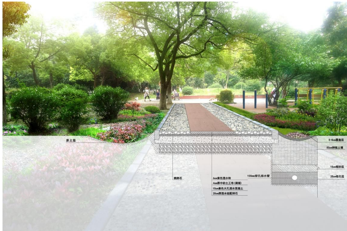
图 8.5.4（1）-1 透水铺装及两侧植草沟实景图（一）
